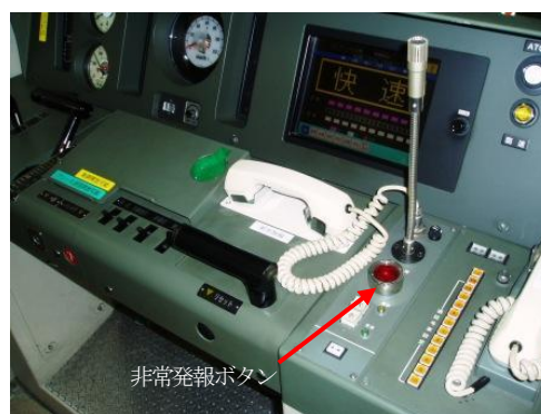
列車無線装置
