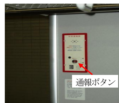
車内非常通報器
