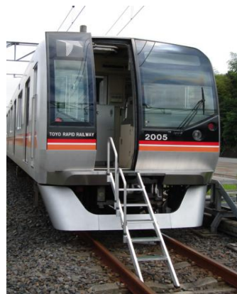
非常脱出梯子
