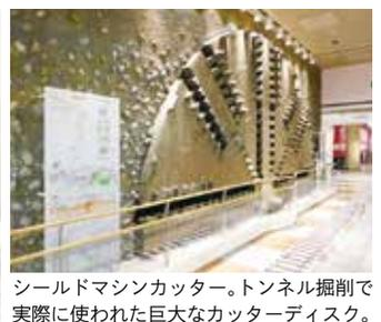
シールドマシンカッター。トンネル掘削で実際に使われた巨大なカッターディスク。
