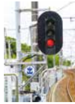
変更前 (WS-ATC) 地上信号機で確認。 ※写真は飯山満駅出発 信号機
